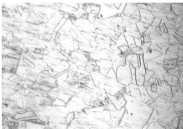
Figura 2 : Microestrutura do metal base ABNT 304 , evidenciando a presença de austenita
