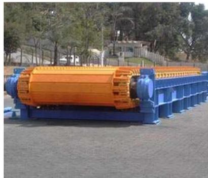
Figura 9: Alimentador de esteira/ sapatas
