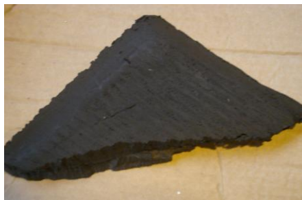
Figura 3 – Foto de uma porção de uma “torta de cake ” gerada em uma das 64 placas que compõem o filtro-prensa.
