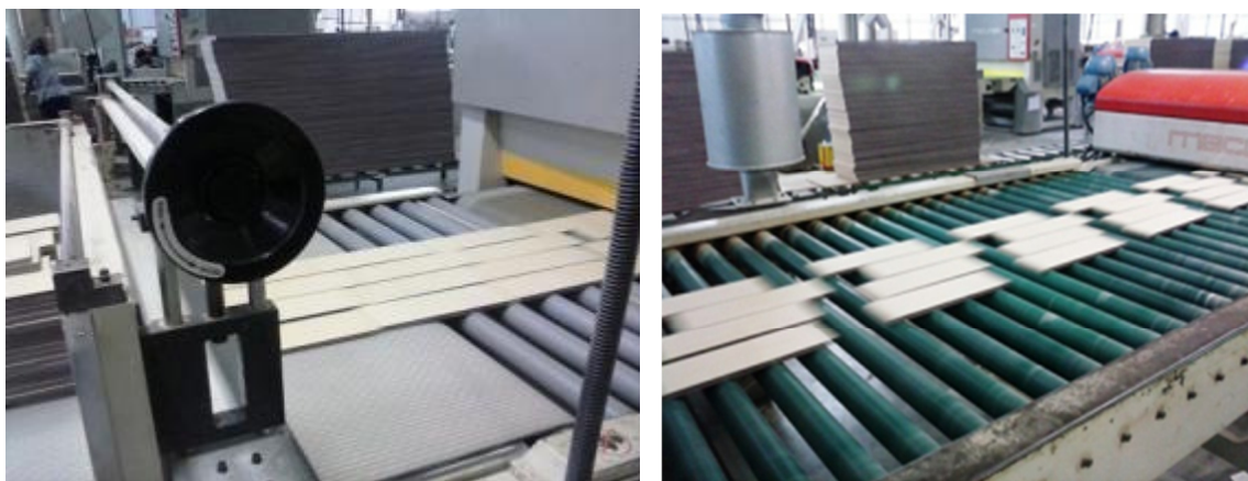
FIGURA 4 e 5 – Alimentador e transfer com as laterais de gaveta antes do plano de pintura.
